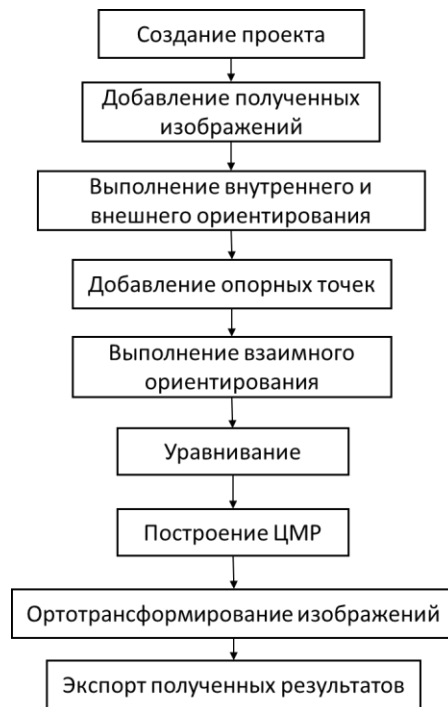
Рисунок 1 Схема обработки полученных данных с БПЛА [3]
